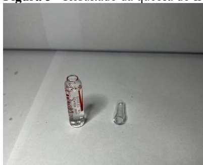
Figura 3 - Resultado da quebra do frasco obtido com o protótipo 2B – frasco de 2ml.
